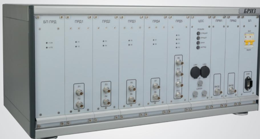
Комплекс предназначен для обнаружения, анализа и подавления радиочастотных линий управления взрывными устройствами при одновременном сохранении возможности использования необходимого оборудования в рабочей зоне комплекса в диапазоне частот от 20 до 2750 МГц.
