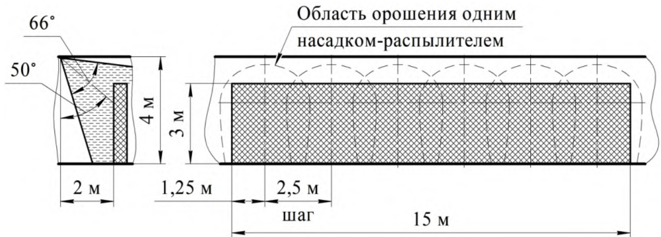
Рисунок 16 – Противопожарная защита боковой поверхности стеллажа 6-ю насадками-распылителями
