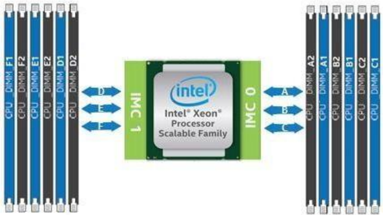
Рисунок 25. Каналы памяти процессора
