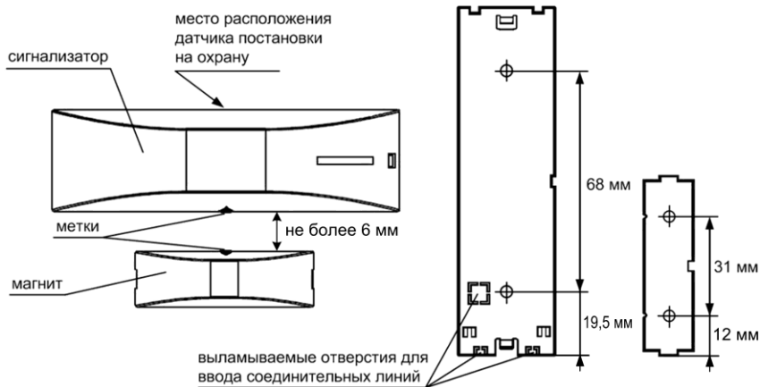
Рис.9 Схема установки, установочные и присоединительные размеры
