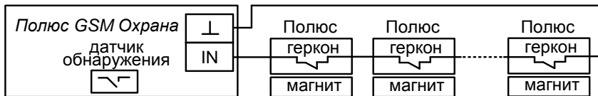
Рис.6б Схема подключения внешних датчиков.
