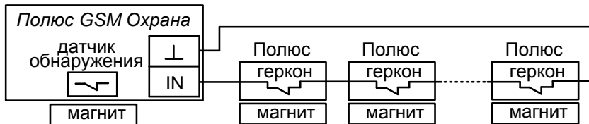
Рис.6а Схема подключения внешних датчиков. Значение «2» параметра №37
