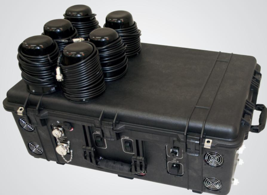
Блокиратор предназначен для противодействия радиоуправляемым взрывным устройствам РВУ посредством генерируемого сигнала во всем диапазоне рабочих частот, предназначен для защиты от РВУ при передвижении на транспортном средстве и в стационарном положении. Используется в условиях плотной городской застройки, когда необходимо обеспечить быструю смену местоположения безопасной зоны обеспечиваемой изделием установленным на ТС.
